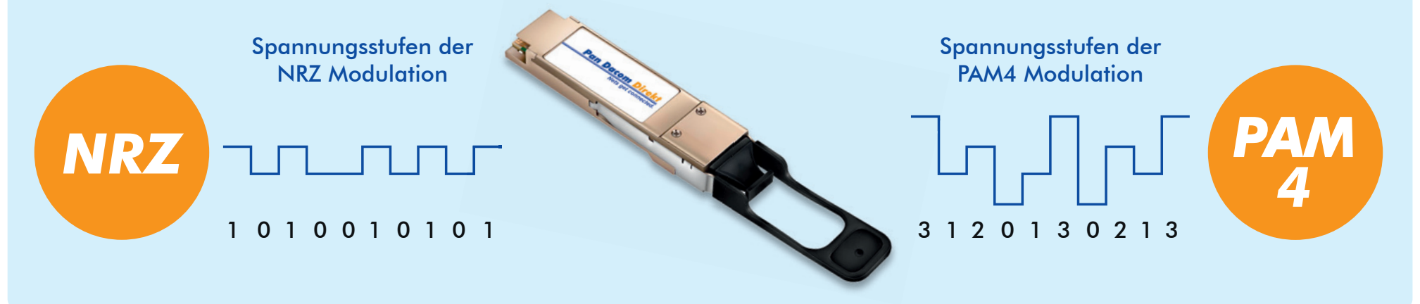
Abb. 3: Vergleich der NRZ und PAM4 Modulation
